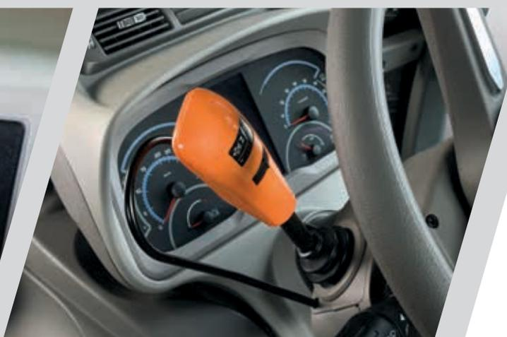
> Inversor electrohidráulico con SenseClutch.
