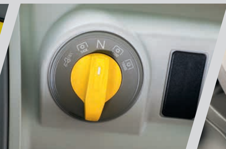
> Seleção da TDF eletro-hidráulica.
