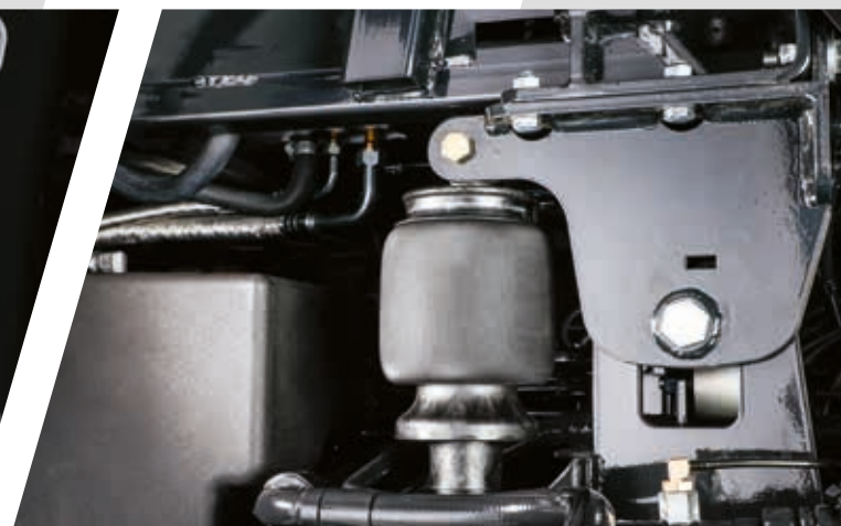
> Pneumatische cabinevering voor de beste rijervaring.
