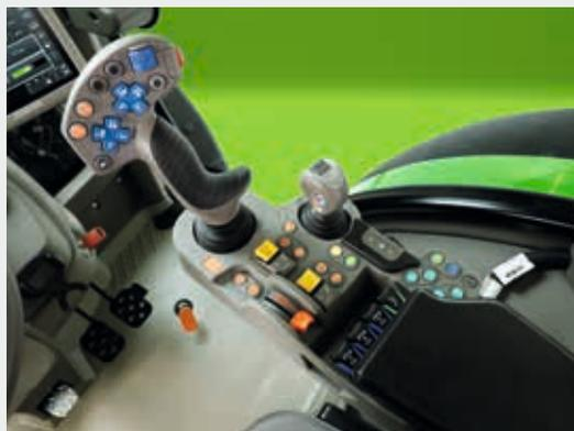
↑ Distributore facilmente controllabile tramite joystick e punta delle dita.
