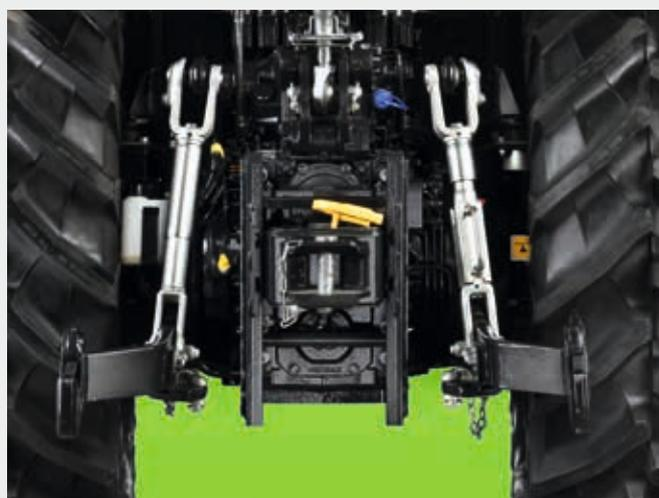
↑ Sollevatore posteriore compatto con tirante idraulico e stabilizzatori.
