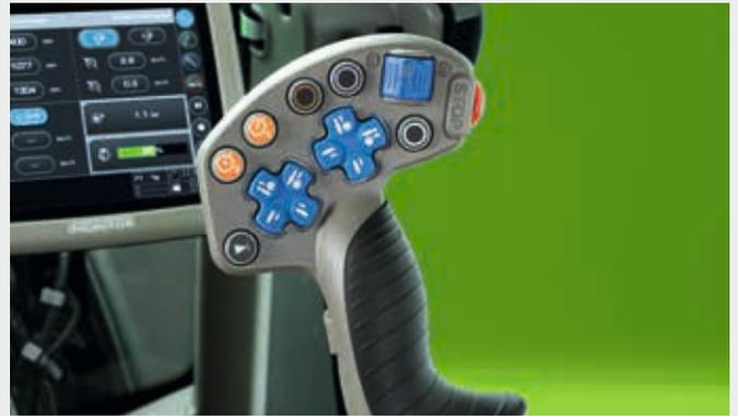
↑ Joystick MaxCom pour une gestion simple de la transmission TTV.
