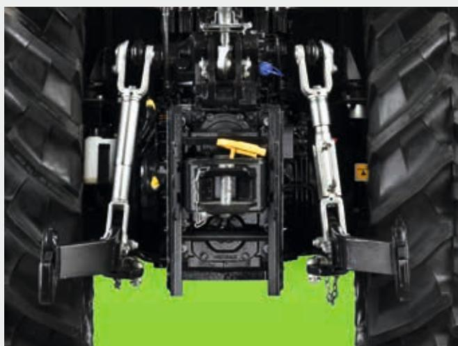
↑ Relevage arrière compact avec chandelle hydraulique et stabilisateurs.
