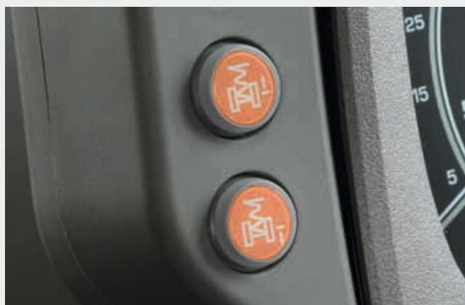
↑ Deux nouveaux boutons dédiés permettant de régler manuellement la position de la suspension avant.
