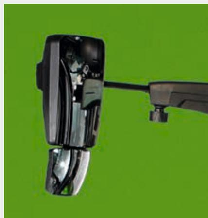
↑ Rétroviseurs à réglage et dégivrage électriques.
