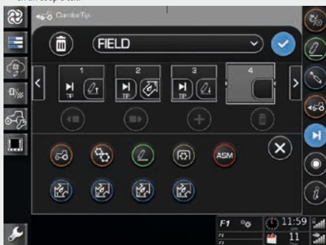
↑ Comfortip augmente ultérieurement le niveau de confort. Il permet d'enregistrer des tâches répétitives et de les rappeler en appuyant sur un seul bouton.
