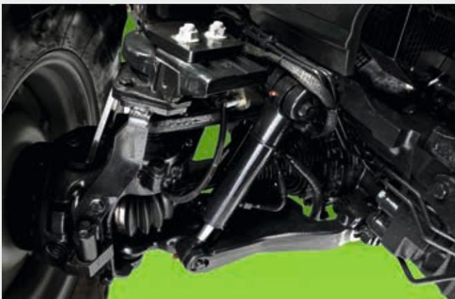
📌 Pont avant suspendu avec freins avant.
