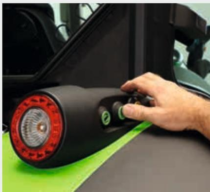
↑ Le relevage arrière et la PDF ont des commandes externes sur les garde-boue arrière.
