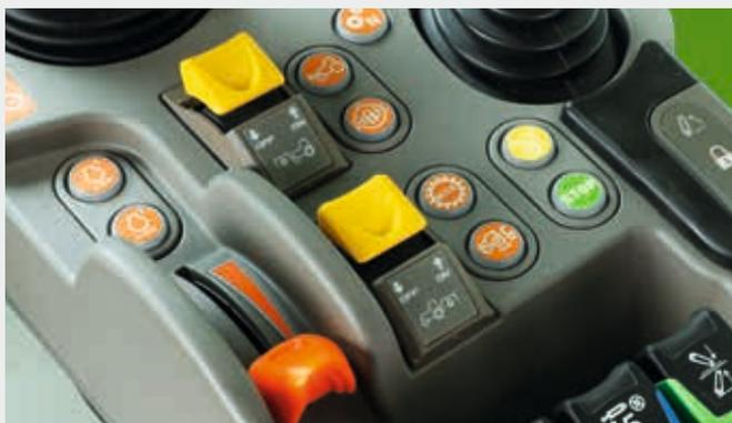
↑ Fácil acoplamiento de la toma de fuerza delantera y trasera mediante los botones del reposabrazos del MaxCom.
