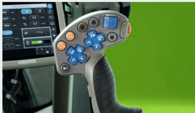
↑ Joystick MaxCom para gestionar con facilidad la transmisión TTV.
