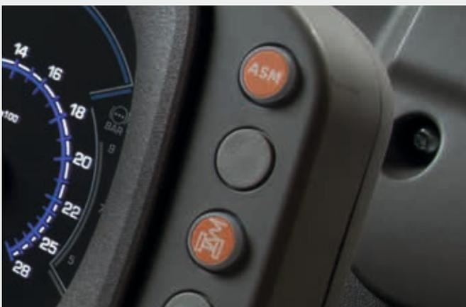
📌 Activación del ASM y de la suspensión del eje delantero.
