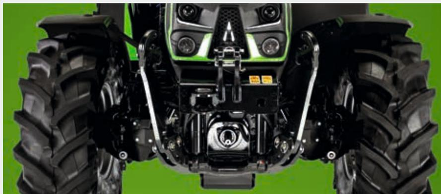
↑ Los modelos 5D TTV se pueden equipar con un elevador delantero de 2100 kg de capacidad y un paquete confort opcional.
