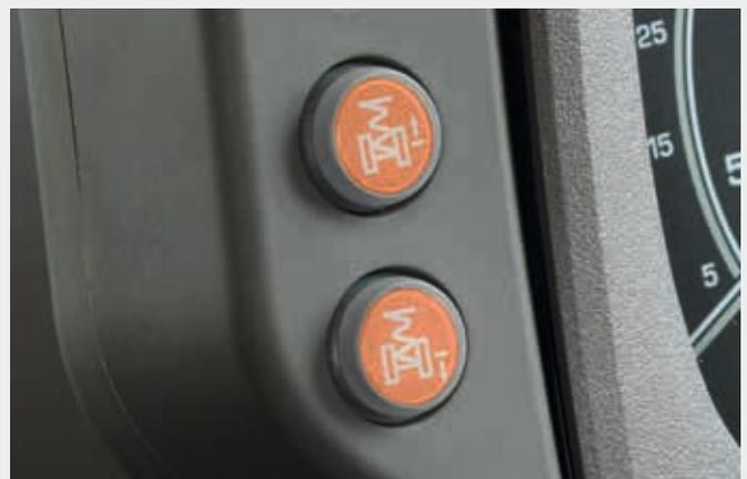
📌 Dos nuevos botones específicos para regular manualmente la posición de la suspensión delantera.
