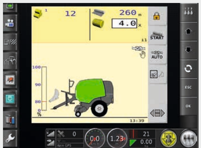
Universal-Terminal zur Steuerung beliebiger ISOBUS-Geräte.
