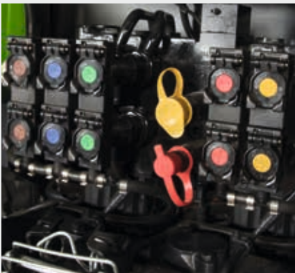
↑ Bis zu 5 Zusatzsteuerventile im Heck.
