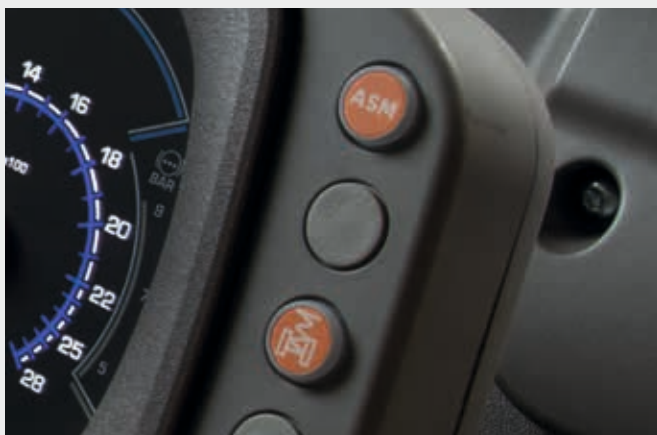
📌 Aktivierung des ASM-Systems und der Vorderachsfederung.
