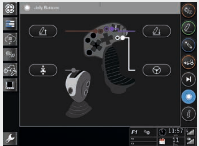
3 frei programmierbare Tasten und 1 programmierbares Daumenrad
