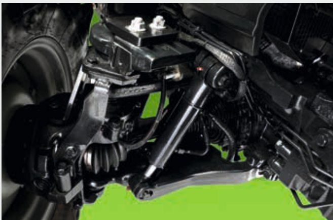
↑ Gefederte Vorderachse mit Vorderradbremßen.
