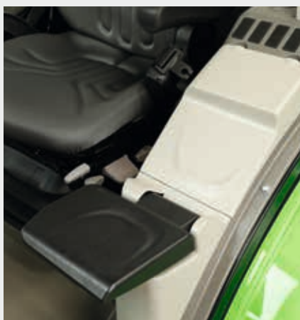
↑ Linke Konsole mit klappbarer Ablage.
