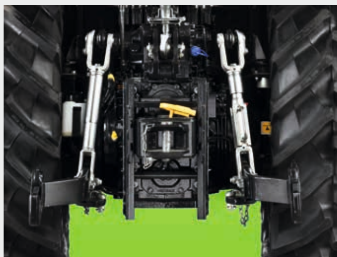
↑ Kompakt-Heckkraftheber mit hydraulischen Seitenstabilisatoren.
