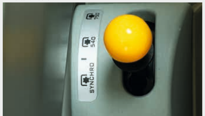
↑ Vorwahl der Zapfwelldrehzahl.
