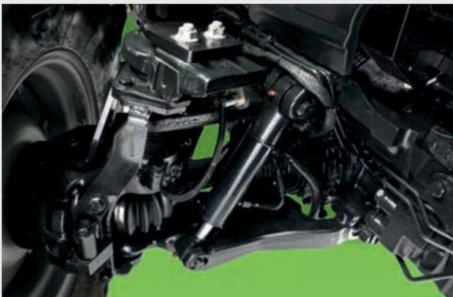
↑ Eixo dianteiro com suspensão e travões dianteiros.
