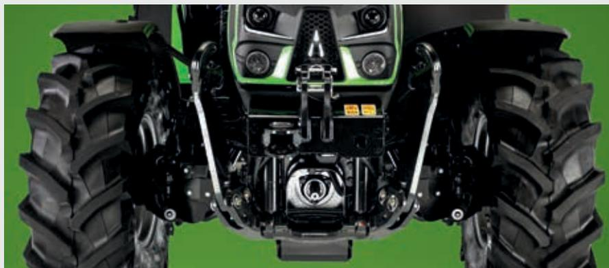
↑ Os modelos 5D TTV podem ser equipados com um elevador dianteiro com capacidade de 2100 kg e pacote conforto opcional.
