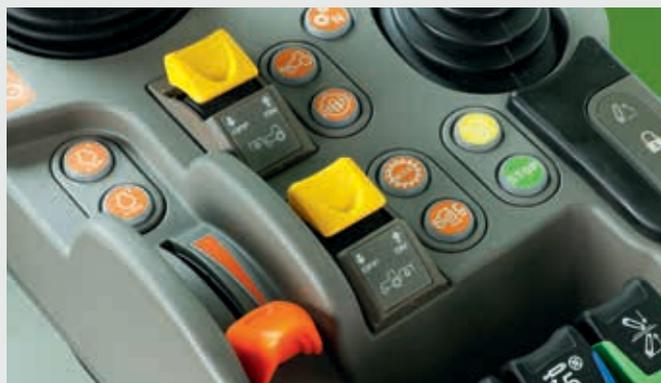
↑ Fácil engate da TDF dianteira e traseira através de botões no apoio de braço MaxCom.
