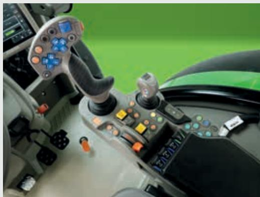
↑ Distribuidor facilmente controlado através do joystick e com a ponta dos dedos.
