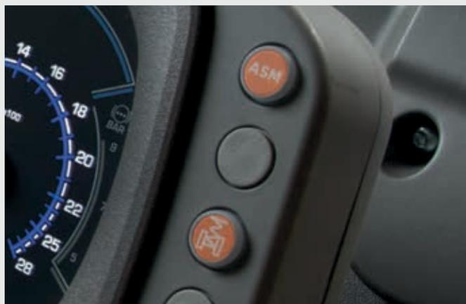
Ativação do ASM e da suspensão do eixo dianteiro.
