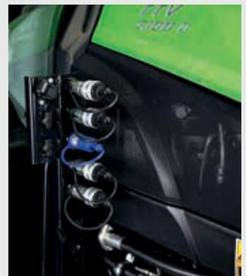
↑ Válvulas hidráulicas de montagem central para acessórios dianteiros.
