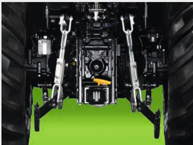
↑ Standaard driepuntsbevestiging voor meer hefvermogen.
