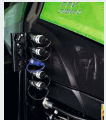
↑ Midden-gemonteerde hydraulische aansluitingen voor werktuigen aan de voorzijde.
