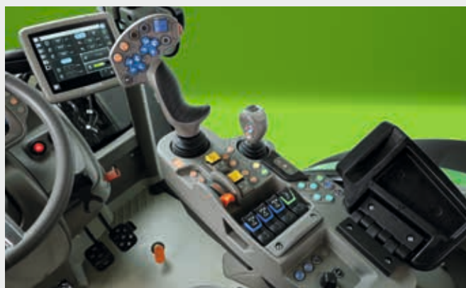
↑ MaxCom-armleuning met intuïtieve kleurcodering voor eenvoudige bediening.
