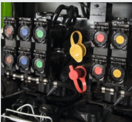
↑ Tot 5 hydrauliekventielen achter.
