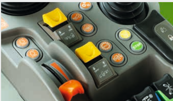
↑ Eenvoudig inschakelen van de PTO voor en achter met behulp van de knoppen op de MaxCom-armleuningen.
