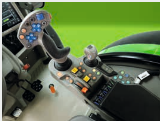
↑ Ventielen gemakkelijk te bedienen met joystick en vingertoppen.
