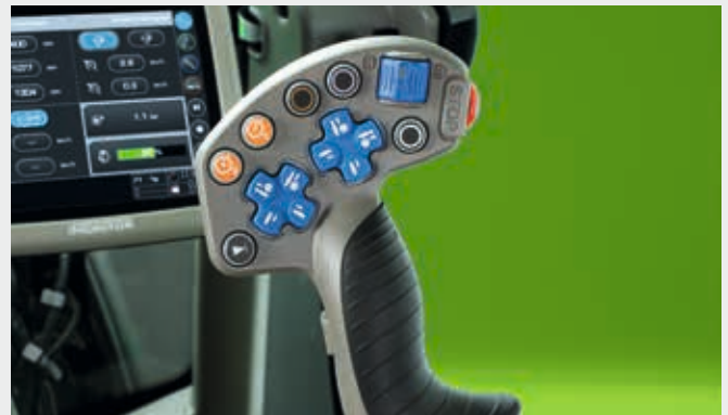
↑ MaxCom-joystick voor eenvoudige bediening van de TTV-transmissie.
