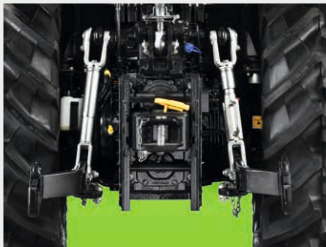
↑ Compacte achterhef met hydraulische topstang en stabilisatoren.
