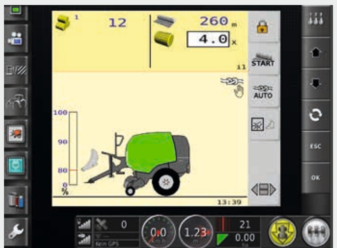
Universele terminal voor de bediening van een ISOBUS-werktuig.
