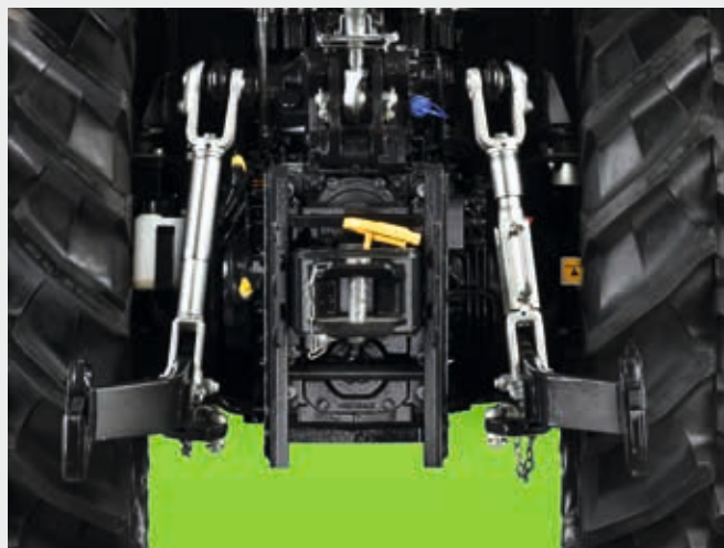
↑ Compacte achterhef met hydraulische topstang en stabilisatoren.
