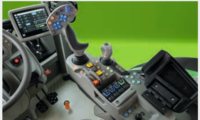
↑ MaxCom-armleuning met intuïtieve kleurcodering voor eenvoudige bediening.
