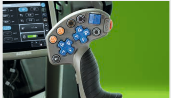
↑ MaxCom-joystick voor eenvoudige bediening van de TTV-transmissie.
