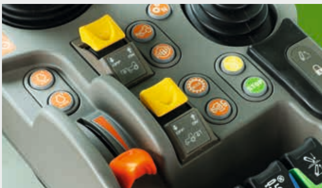
↑ Eenvoudig inschakelen van de PTO voor en achter met behulp van de knoppen op de MaxCom-armleuning.
