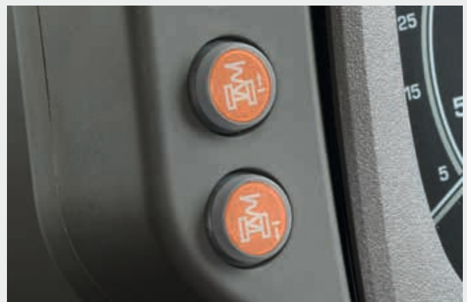
↑ Twee nieuwe speciale knoppen voor handmatige instelling van de positie van de voorasvering.
