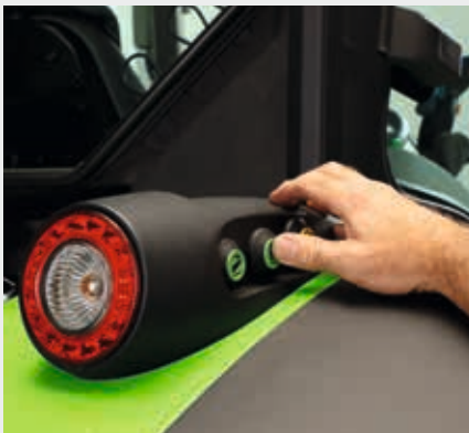
↑ De hefinrichting en aftakas achter beschikken over externe bedieningsknoppen op de achterspatborden.
