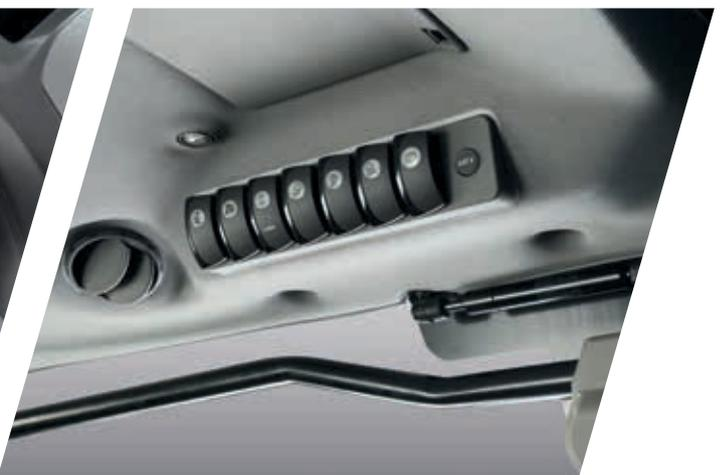
> La protection contre les aérosols de pesticides, assurée par une filtration de catégorie 4, peut être facilement activée par un bouton.
