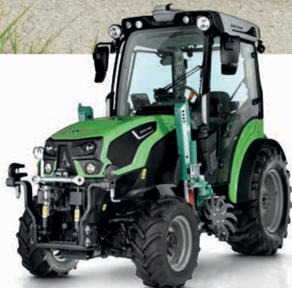
> Plusieurs tailles de pneus PneuTrac sont disponibles en option, ce qui permet de réduire le compactage du sol et d'améliorer la stabilité latérale par rapport aux pneus conventionnels.
