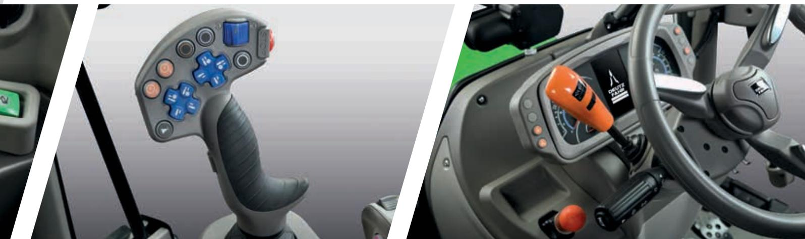
> joystick MaxCom permettant de gérer facilement la vitesse de conduite.
