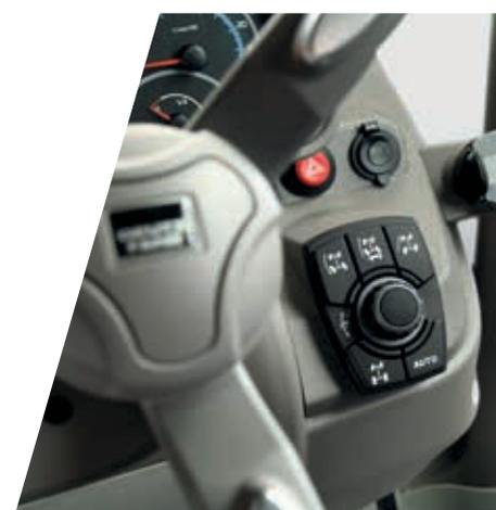
> Les modes de direction sont facilement sélectionnables grâce à la commande spécifique située sur le côté droit du volant.
