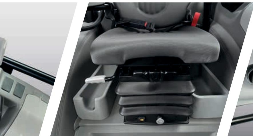
> Según el tamaño del tractor, puede incluir hasta dos bandejas de almacenamiento/portabotellas.
