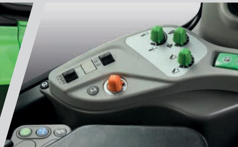
> El conductor puede seleccionar entre diferentes modos de gestión del motor, desde "ECO" hasta "Power", para disponer de la máxima potencia.
