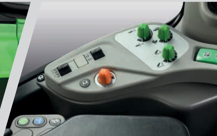
> Der Fahrer kann per Drehpoti selbst das Motormanagement von „Eco“ bis „Power“ für maximale Leistung einstellen.
