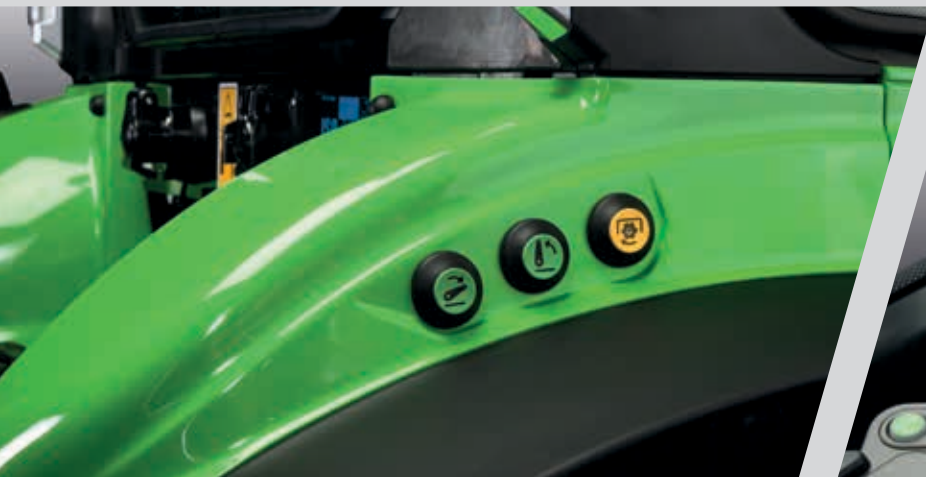
> Externe Bedienung für Zapfwelle und Heckkraftheber am linken und rechten Kotflügel.
