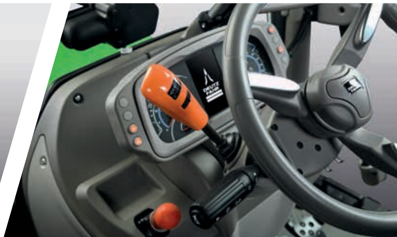
> PowerShuttle mit SenseClutch (5 Einstellstufen für das Ansprechverhalten).
