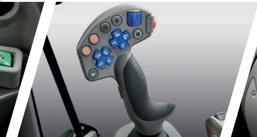
> MaxCom-Joystick für eine einfache Bedienung der Fahrfunktionen.
