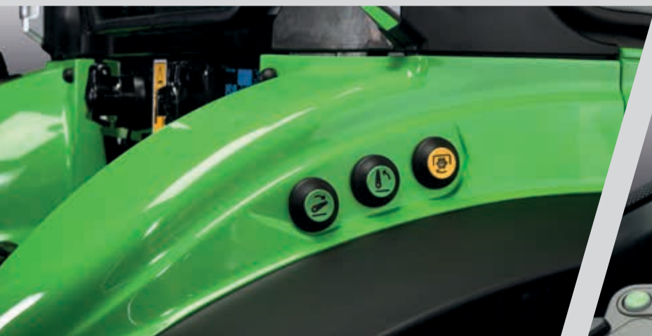
> TDF externa e botões de elevação traseiros nos guarda-lamas esquerdo e direito.
