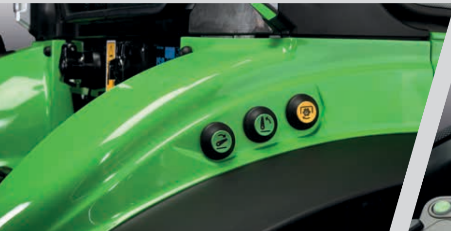
> Przyciski WOM i tylnego podnośnika na lewym i prawym błotniku.
