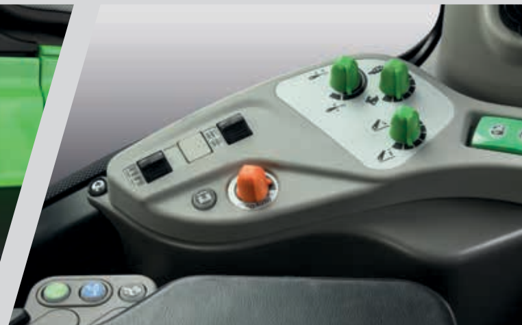
> Operator może regulować zakres obrotów w zakresie od „ECO” do „Power”, aby uzyskać maksymalną moc.
