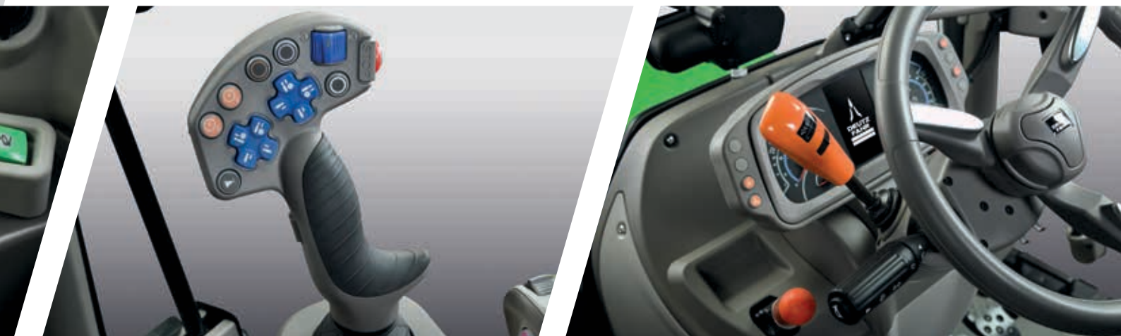
> Joystick MaxCom umożliwiający łatwe zarządzanie prędkością jazdy.
