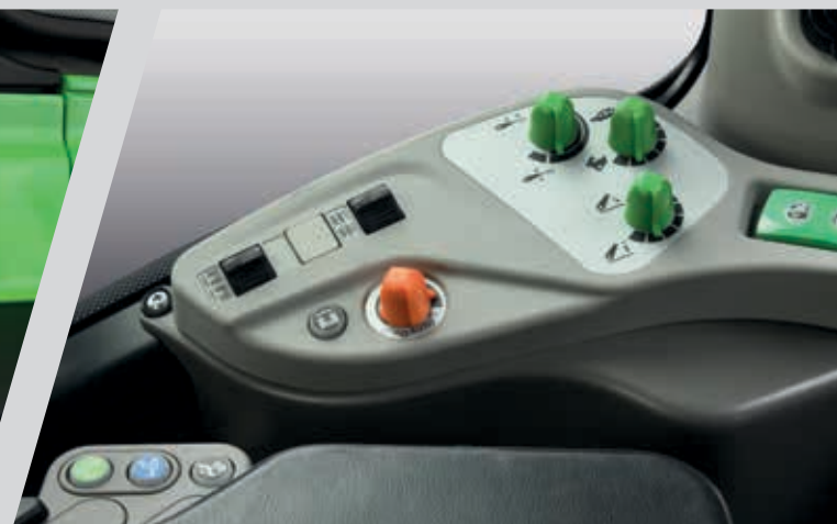
> De bestuurder kan kiezen uit meerde standen voor motormanagement, van "ECO" tot "Power" voor maximaal vermogen.
