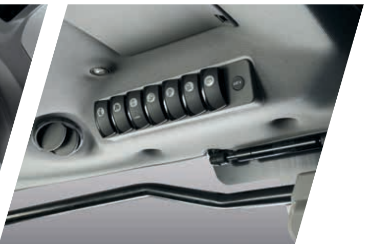
> Bescherming tegen aerosolen van pesticiden door Cat.4 filtratie, eenvoudig in te schakelen met een knop.
