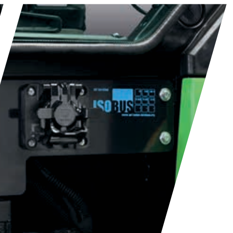
> ISOBUS: kunt u elk type werktuig aansluiten en gebruik maken van diverse ISOBUS-functies.
