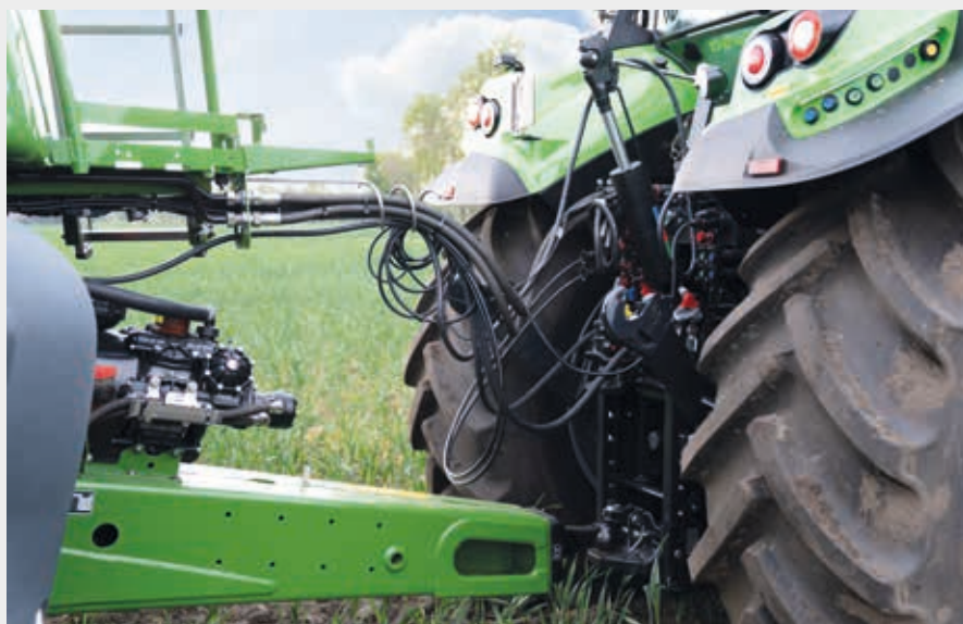
↑ Tylny podnośnik w pozycji transportowej nie koliduje z dyskami przyczep podczas skręcania.
