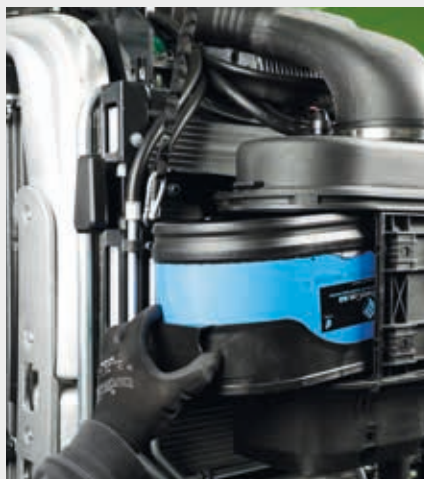
↑ Filtr powietrza ze wstępnym oczyszczeniem.
