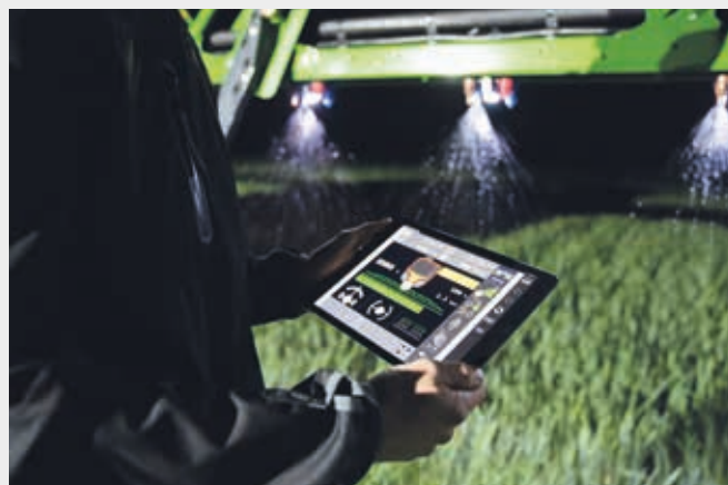
↑ Funkcja XTEND - tablet, kontrola maszyn w systemie ISOBUS UT nawet poza kabiną.
