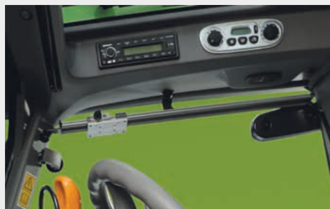
Elementy sterujące radiem, klimatyzacją i oświetleniem oraz przesuwny uchwyt monitora.
