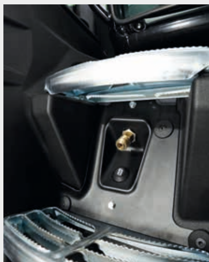
↑ Złącze pneumatyczne i przełącznik oświetlenia wejściowego w bezpiecznym miejscu pod schodkami.
