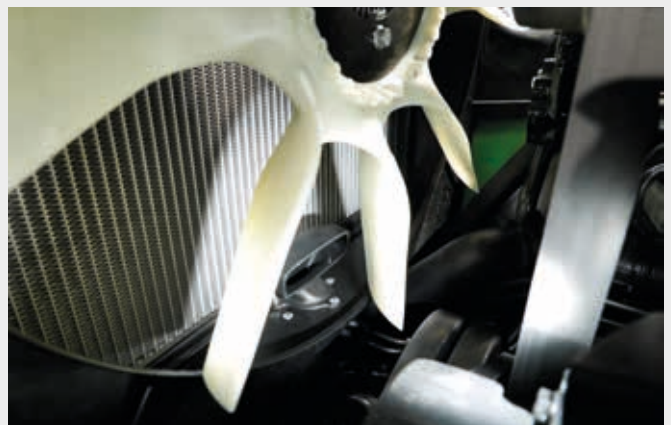
↑ Elektroniczny wentylator wiskotyczny (eVisco) z zasysaniem zanieczyszczeń z filtra (usuwa 95% grubszych cząstek, zanim dotrą do filtra).
