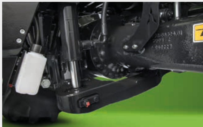
↑ Przednia oś modelu 6190 TTV z solidnym dolnym wahaczem.
