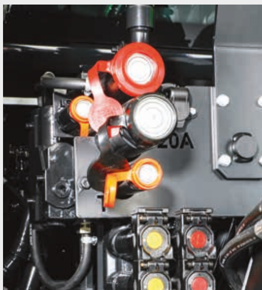
↑ Power Beyond z płaskimi złączami zapewniającymi czyste połączenia.
