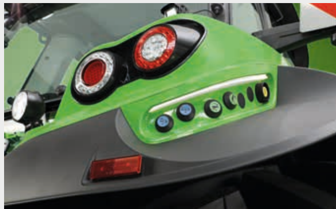
↑ Podświetlane przyciski zewnętrznego sterowania podnośnikiem, WOM obwodem hydraulicznym.
