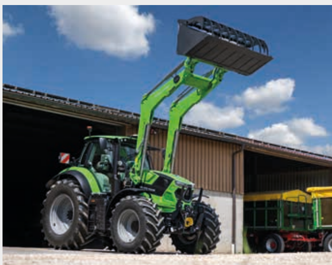
↑ Maksymalna wysokość unoszenia 4,5 m i moment zrywający 3770 daN.
