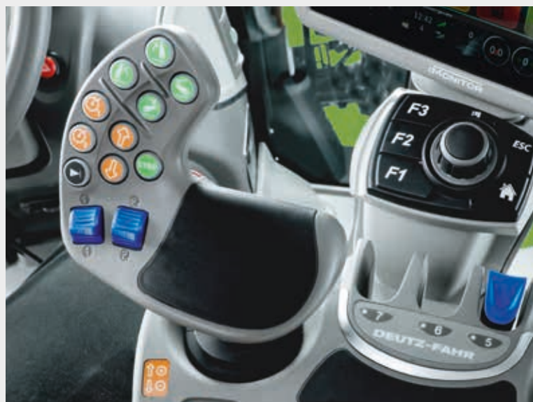
Ergonomiczny joystick MaxCom z przyciskami do obsługi podnośnika, silnika, przekładni, zachowania na wrotkach oraz dwie jednostki sterujące proporcjonalnymi zaworami hydraulicznymi.
