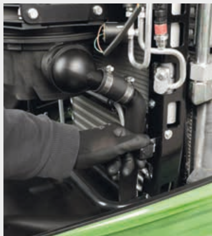
↑ Układ chłodzenia z łatwym do otwarcia mechanizmem.
