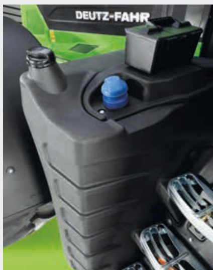
↑ Maksymalna pojemność zbiornika paliwa 505 l wydłuża czas pracy.
