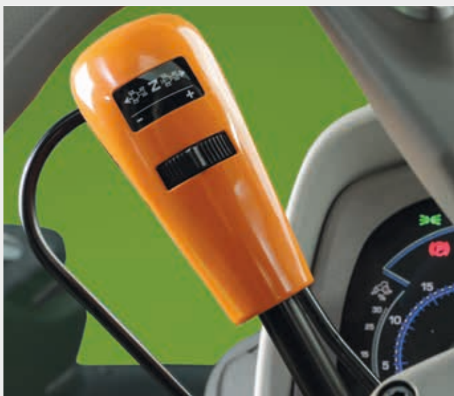
PowerShuttle z Sense Clutch i pięcioma poziomami regulacji.
