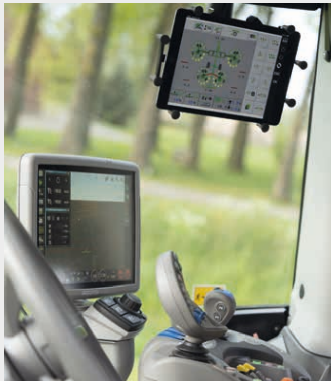
↑ XTEND umożliwia wyświetlanie funkcji SDF Guidance lub pozwala Ci kontrolować narzędzie ISOBUS za pomocą zewnętrznego urządzenia, np. tabletu.
