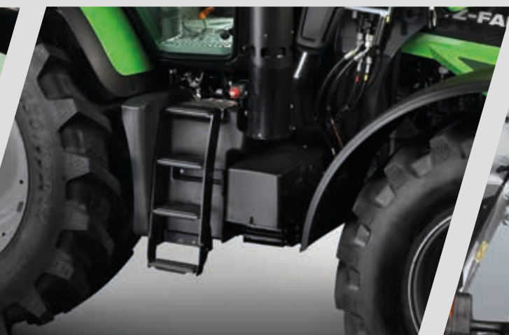
> Головний вимикач акумулятора та відсік для акумулятора з правого боку трактора.
