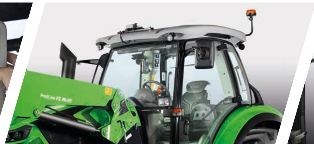
> Точний приймач SR20 на даху кабіни.
