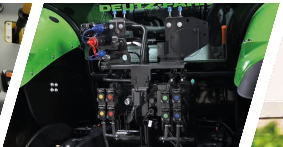
> Задня зона кріплення з чотирма механічними клапанами та з'єднувачами Power Beyond.
