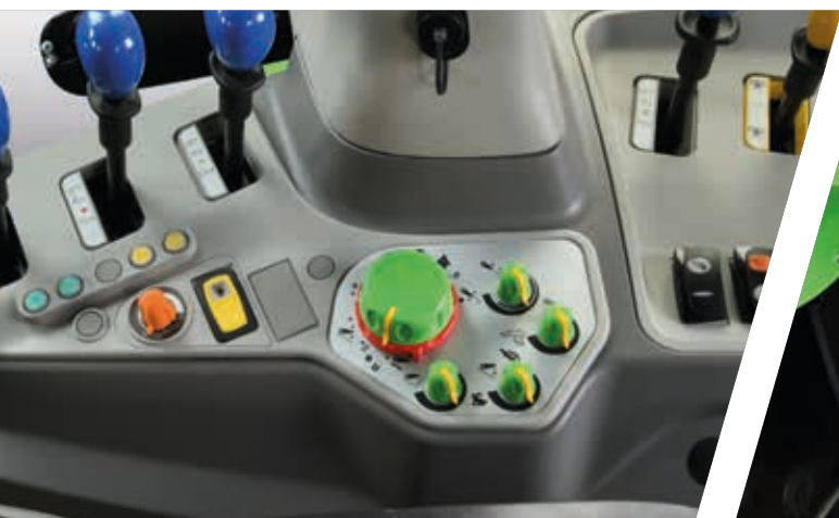
> Чотири легкодоступні та ергономічні важелі управління для керування гідравлічними клапанами з механічним приводом
