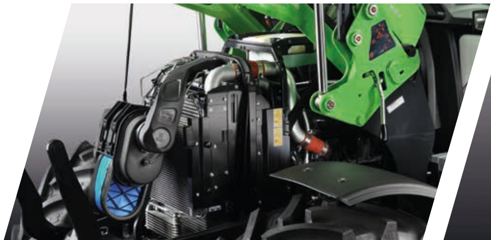
> Легкий доступ до повітряного фільтра PowerCore та радіатора.
