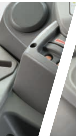
> Ергономічний важіль PowerShuttle з регулятором SenseClutch.
