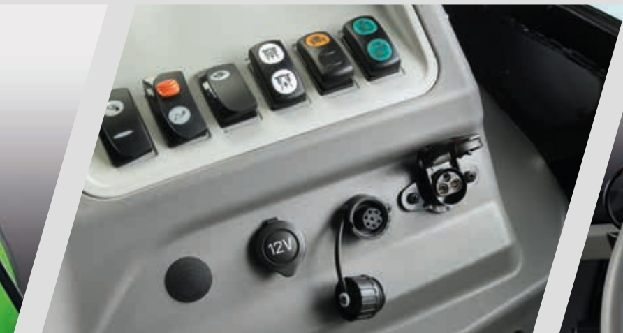
> Кнопки керування фронтальним навантажувачем та електричні розетки.
