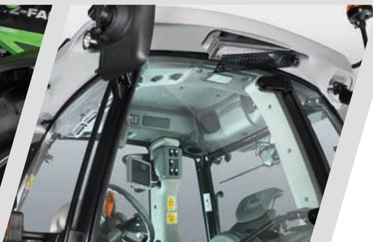
> Повітряні фільтри кабіни легко доступні з нижньої сторони даху.
