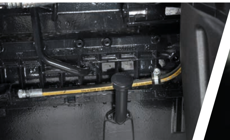
> Щуп моторної оливи доступний без відкриття капота.
