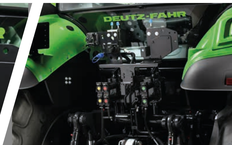
> Задня зона кріплення з трьома механічними клапанами.
