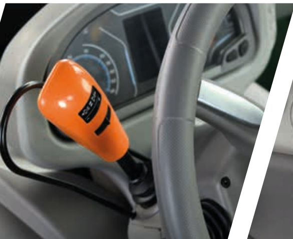
> Ергономічний важіль PowerShuttle з регулятором SenseClutch.
