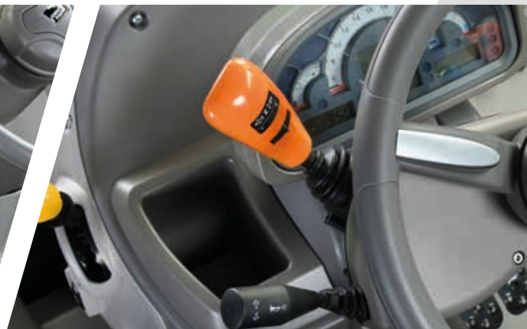
> PowerShuttle met SenseClutch met verstelling op 5 niveaus.
