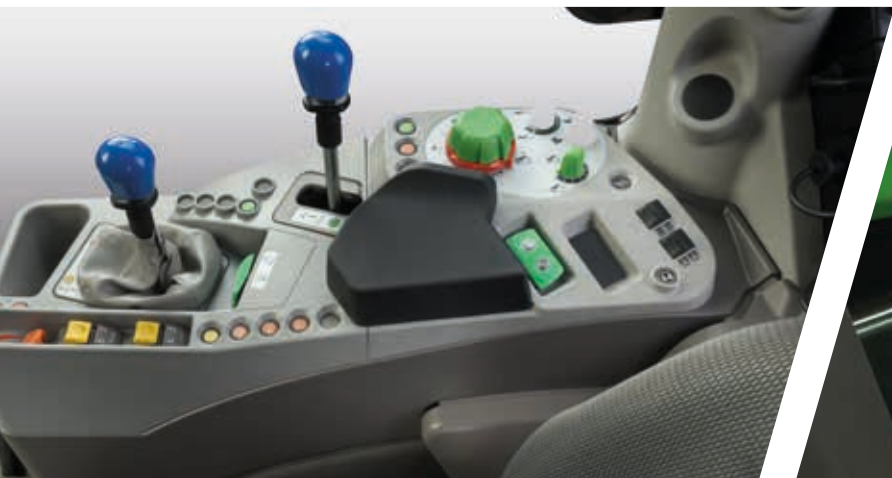
> Achterste distributiekleppen bediend door enkele hendels of mechanische kruishendel.
