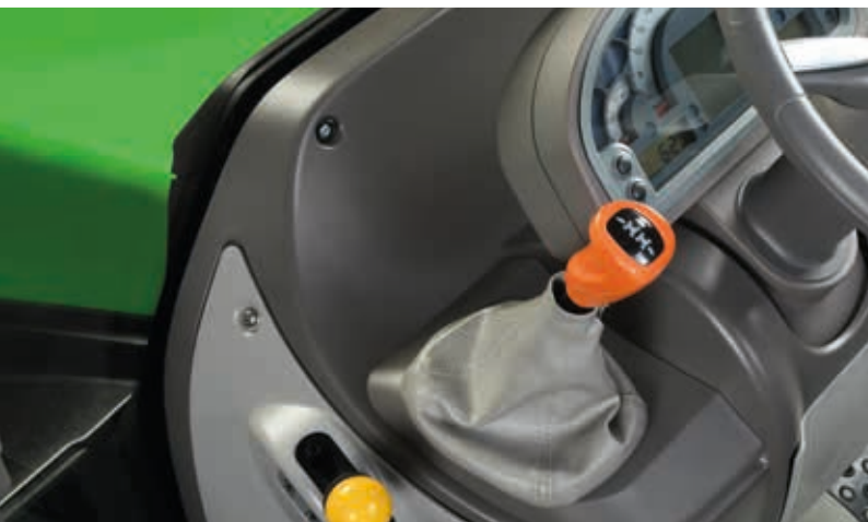
> Mechanische omkeerschakeling met ergonomische hendel op stuurkolom.
