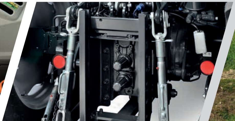
> Синхронний вал відбору потужності з незалежним валом.
