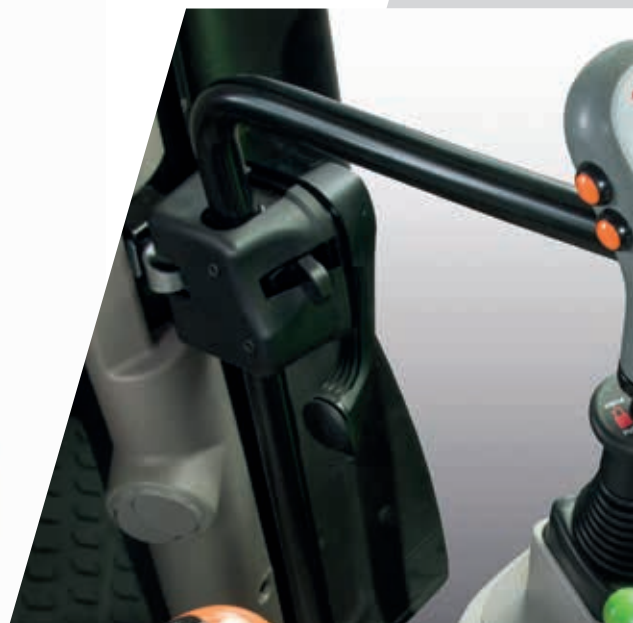
> Джойстик з керуванням Powershift для легкого переміщення фронтального навантажувача.
