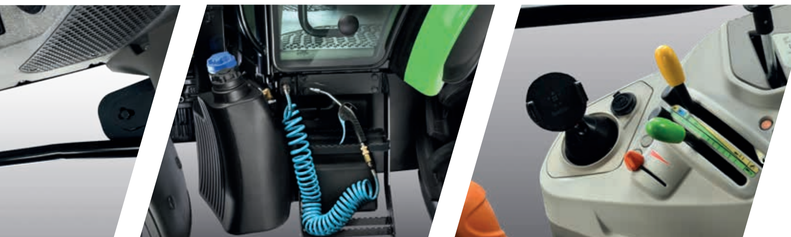
> Зовнішні та внутрішні пневматичні з'єднання для аксесуарів пневматичного компресора.
