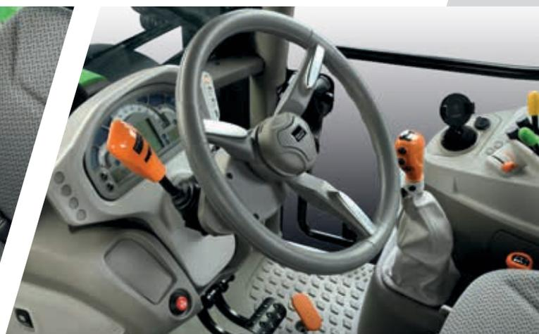
> PowerShuttle avec SenseClutch à 5 niveaux de réglage et fonction Stop&Go.
