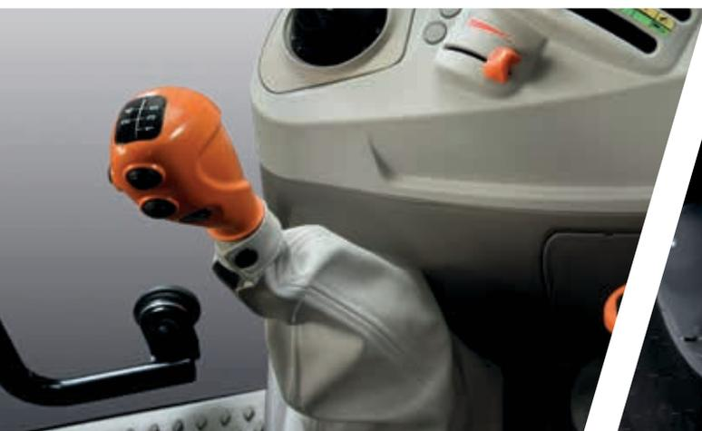
> Levier de vitesse ergonomique avec commandes de transmission Powershift et ComfortClutch.
