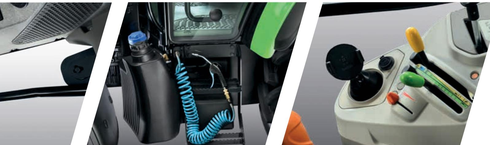
> Raccords d'air externes et en cabine pour les accessoires du compresseur d'air.
