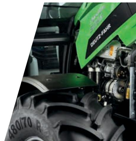
> Moteur FARMotion d'une puissance de 95 à 126 CH.
