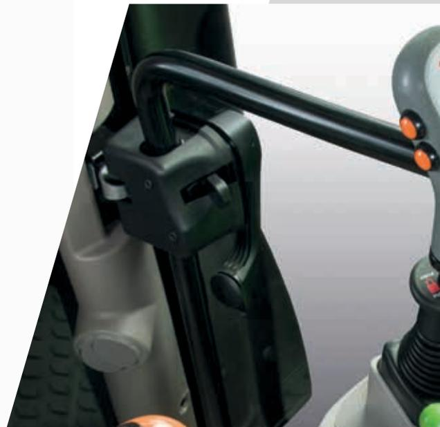
> Commande à joystick Powershift pour faciliter les mouvements du chargeur frontal.
