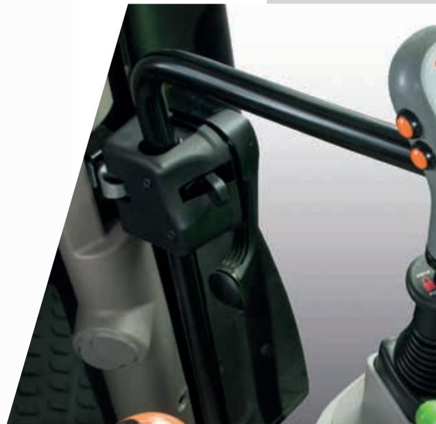
> Joystick con mando Powershift para facilitar el movimiento del cargador frontal.
