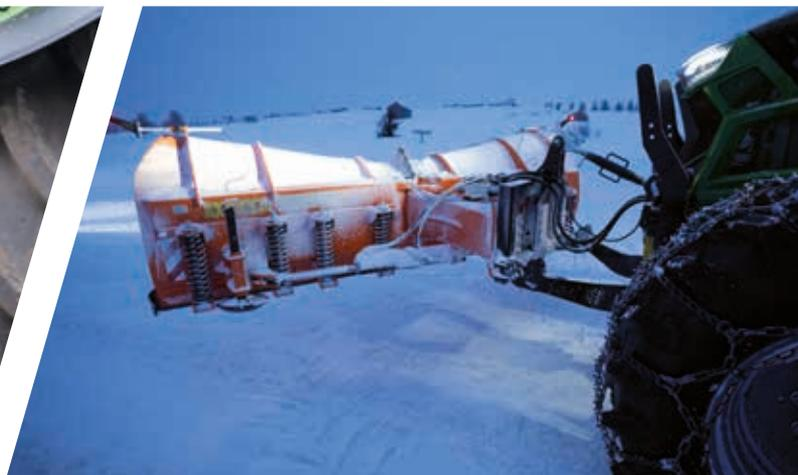
> Relevage arrière avec position de transport pour que les bras inférieurs n'entrent pas en collision avec les barres d'attelage dans les virages (pour 6190 TTV - 6230 HD TTV).
