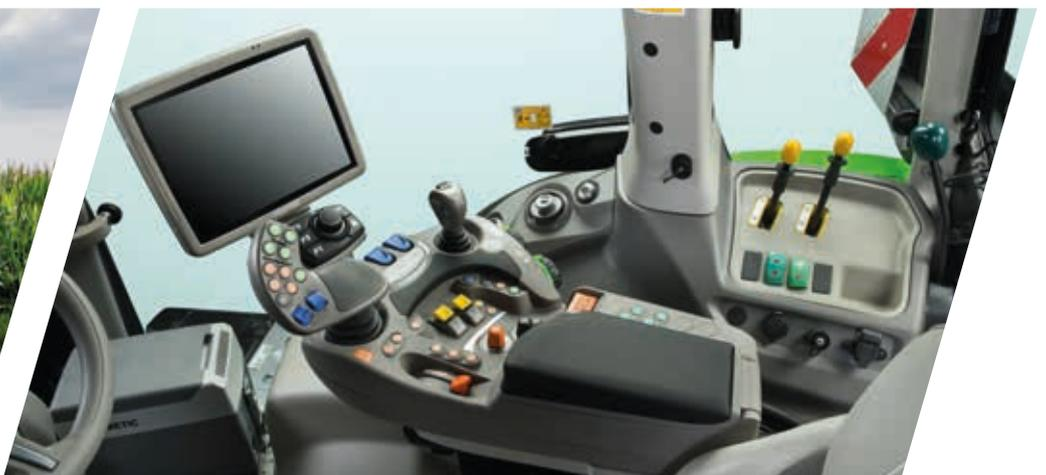
> Joystick ergonomique MaxCom avec boutons de levage, commandes moteur/transmission, bouton de gestion en tournière et deux boîtiers électroniques de distributeur hydraulique proportionnel.
