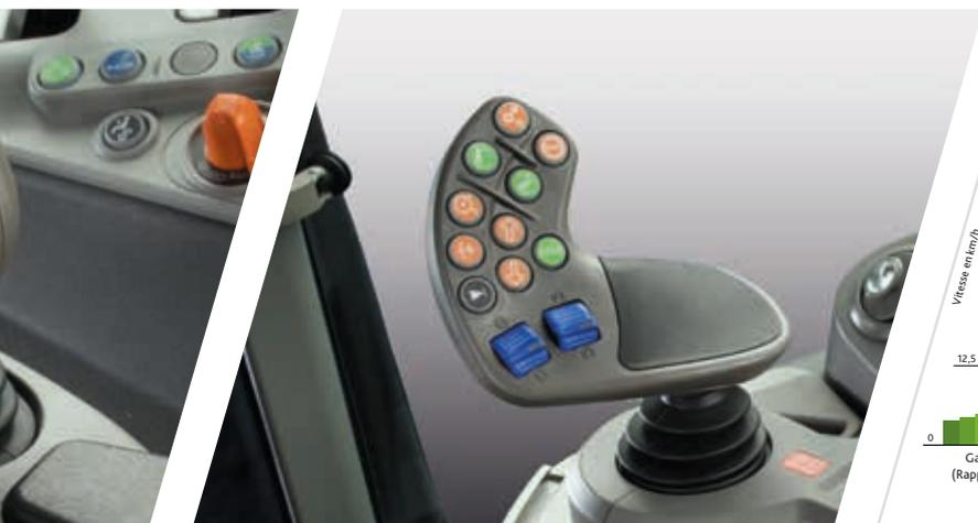
> Gestion simple et intuitive de la transmission grâce au joystick MaxCom, pratique et ergonomique.
