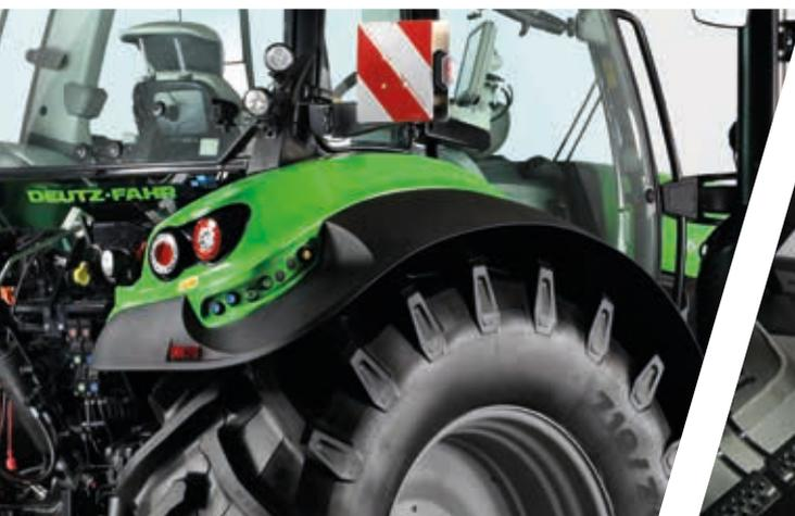
> Commandes extérieures des deux côtés pour le relevage arrière, la PDF et jusqu'à un distributeur.
