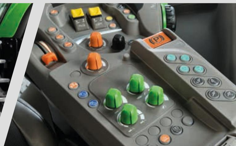
> Réglages du relevage arrière sous le cache de l'accoudoir sur les modèles équipés de la cabine MaxiVision™.
