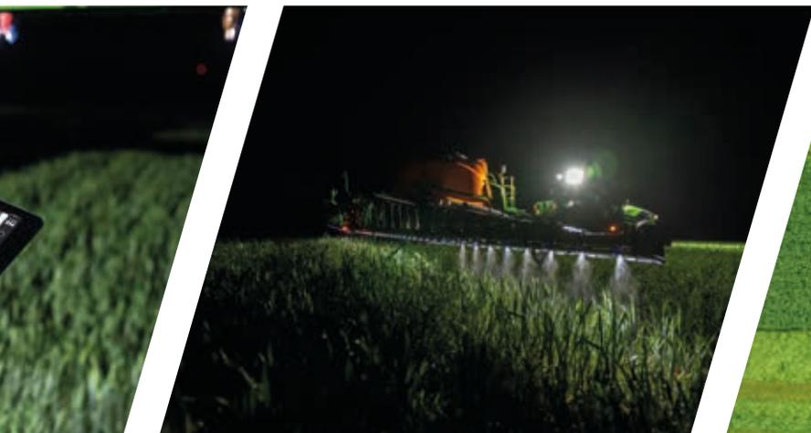
> Avec le contrôle parcellaire automatique et le pulvérisateur à une commande de buse, il est possible d'économiser les agents phytosanitaires. Le contrôle parcellaire automatique (jusqu'à 255 sections) est une fonction de série de l'iMonitor.
