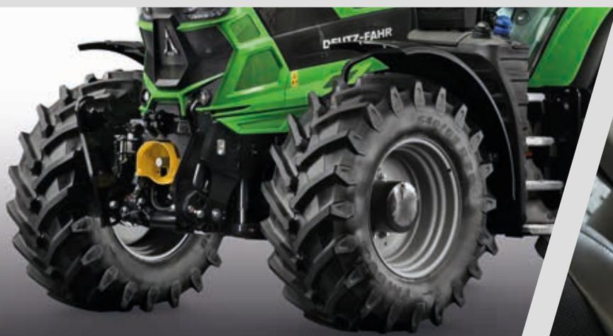
> Relevage avant HD d'une capacité de levage allant jusqu'à 5 450 kg.
