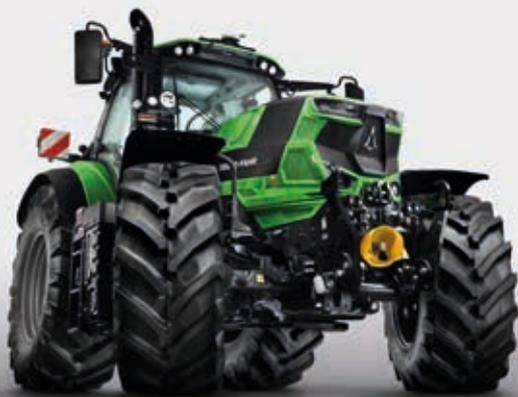
> Pont avant suspendu avec blocage intégral du différentiel avant.
