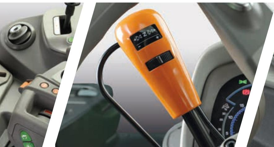
> Levier d'inverseur PowerShuttle avec molette de réglage SenseClutch.
