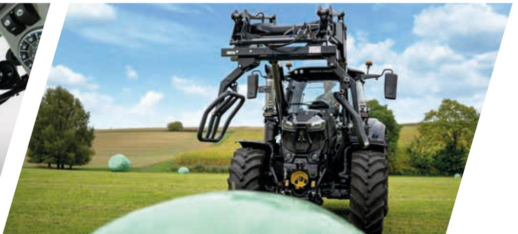
> Les nouveaux chargeurs frontaux ProfilLine intègrent toutes les conduites hydrauliques à l'intérieur de la poutre afin de les protéger et de garantir au conducteur une vue dégagée.
