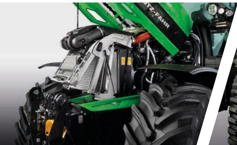
> Système de refroidissement Performance<sup>+</sup> en aluminium avec levier de déblocage d'une main pour les modèles 6160-6190.
