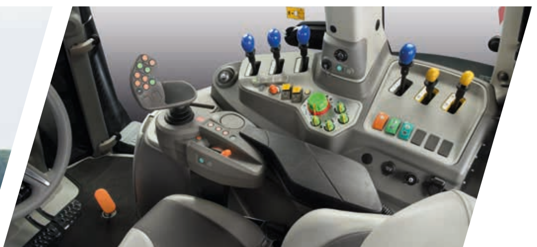
> Die MaxiVision-Kabine mit vollmechanischen Hecksteuergeräten ist für Powershift- (großes Bild) und RCshift- (Bild oben) Modelle erhältlich
