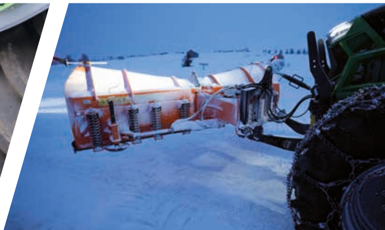
> Der Frontkraftheber mit Entlastungssteuerung ermöglicht die Anpassung des Anpressdrucks des Arbeitsgeräts und verlagert das Gewicht auf die Vorderachse für mehr Traktion.
