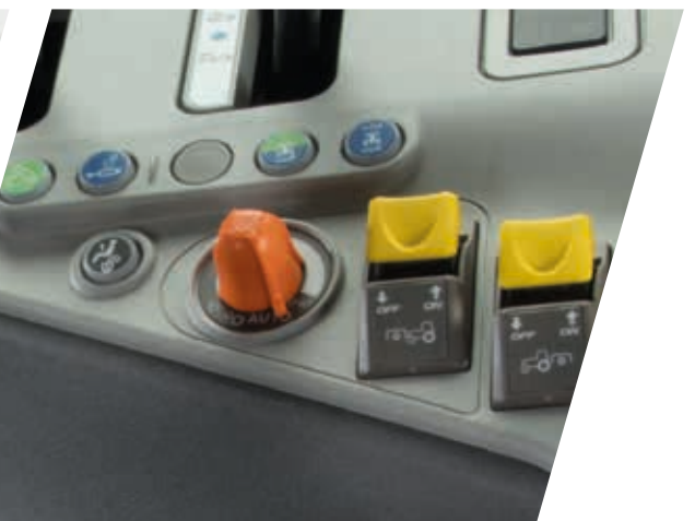
> Einfach und intuitiv – mit dem ECO/Power-Regler kann der Fahrer das APS (Automatic Powershift)-Schaltverhalten ändern.
