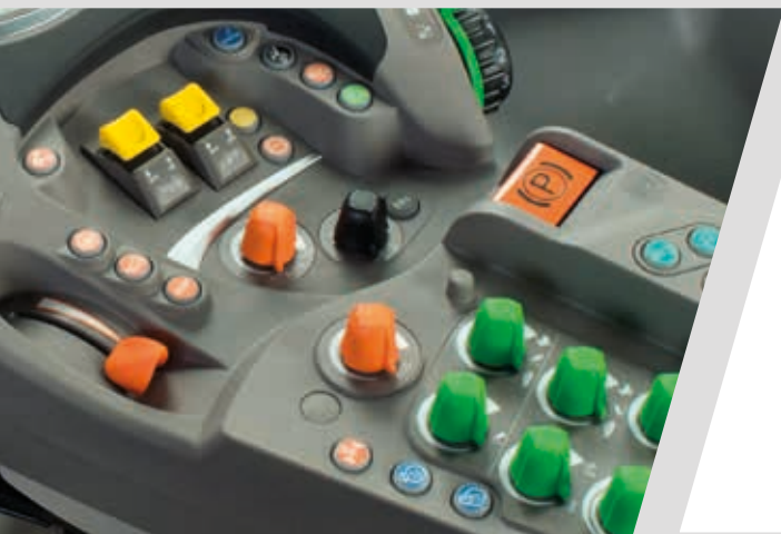
> elektronischer Handgashebel und zwei Tempomaten
