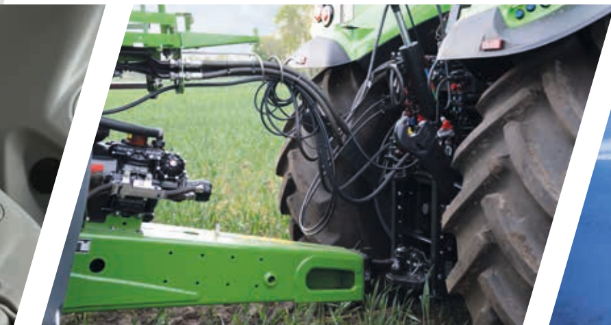
> Heckkraftheber mit Transportstellung, damit die Unterlenker bei Kurvenfahrten nicht mit angebauten Anhängern kollidieren (für 6190 TTV - 6230 HD TTV).
