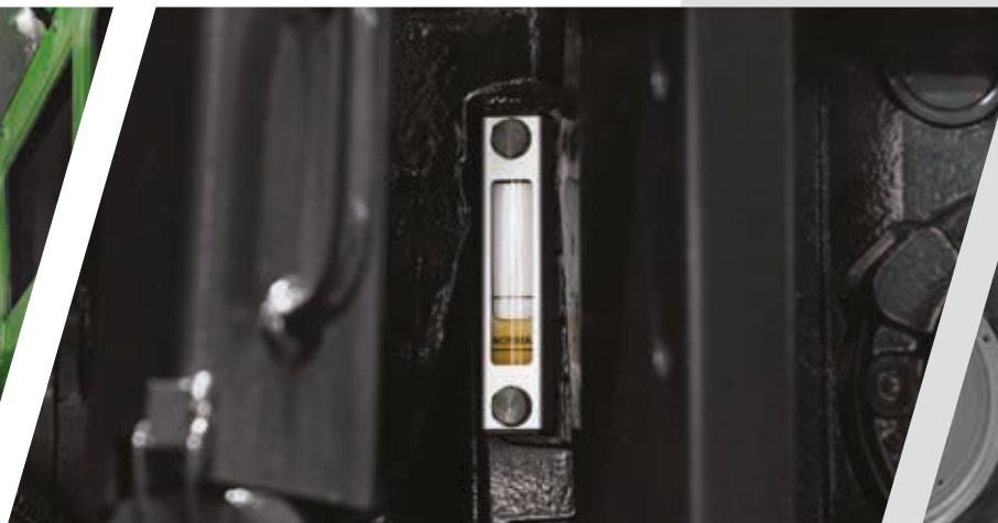
> Leicht zugängliches Ölschauglas am Heck des Traktors.
