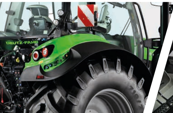
> Externe Bedienelemente auf beiden Seiten für Heckkraftheber, Zapfwelle und bis zu ein Steuergeräte.
