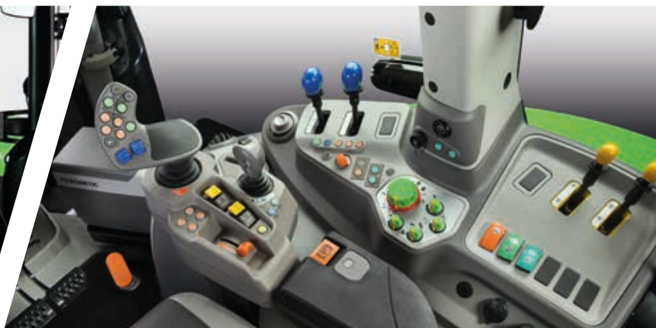
> Gemischte Konfiguration mit 2 mechanischen und 2 elektrischen Steuergeräten.
