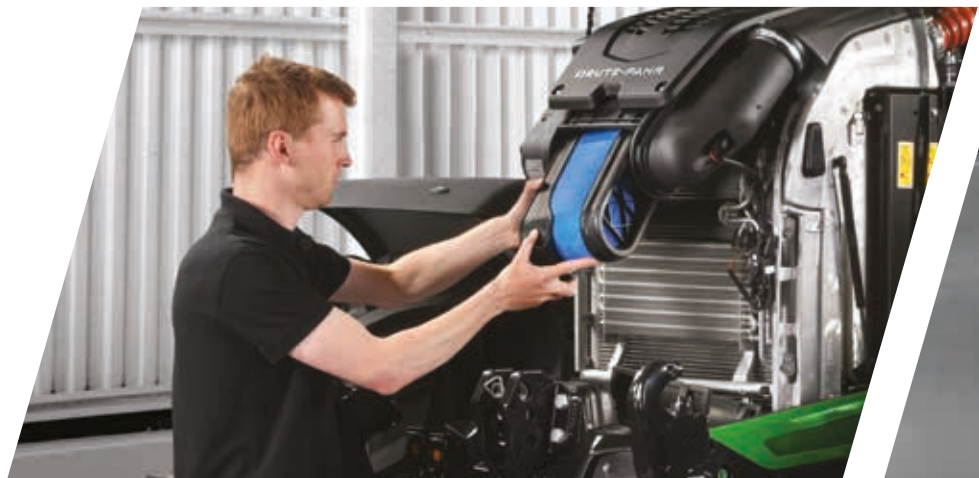
> Alle Modelle sind mit einem PowerCore-Luftfilter ausgestattet, der eine lange Lebensdauer garantiert.
