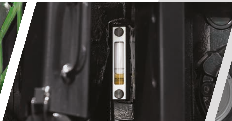
> Leicht zugängliches Ölschauglas am Heck des Traktors.
