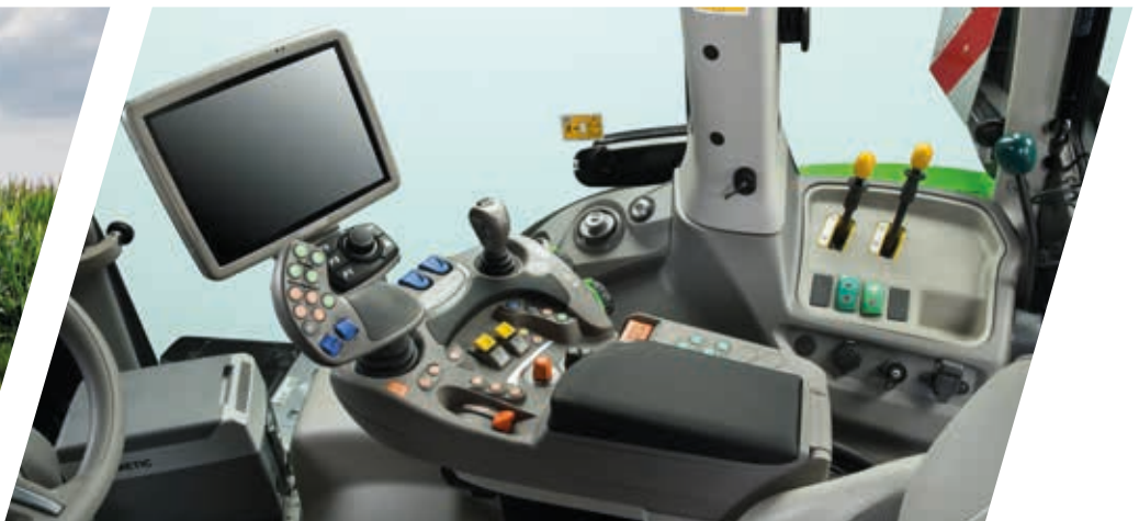
> Ergonomischer MaxCom-Joystick mit Krafthebertasten, Motor- und Getriebebesteuerung, Vorgewendemanagement und zwei proportionalen Hydraulikventilen.
