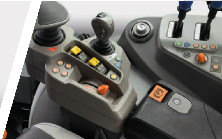
> Elektronische Feststellbremse (EPB) bei TTV-Modellen.
