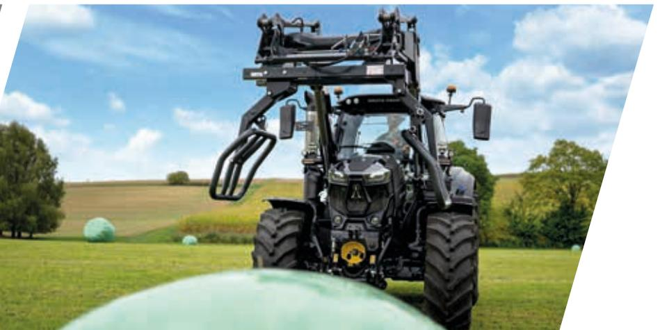
> Os novos carregadores frontais ProfiLine integram todas as linhas hidráulicas dentro dos montantes, para garantir que estão bem protegidas e o condutor tem uma visão desobstruída.
