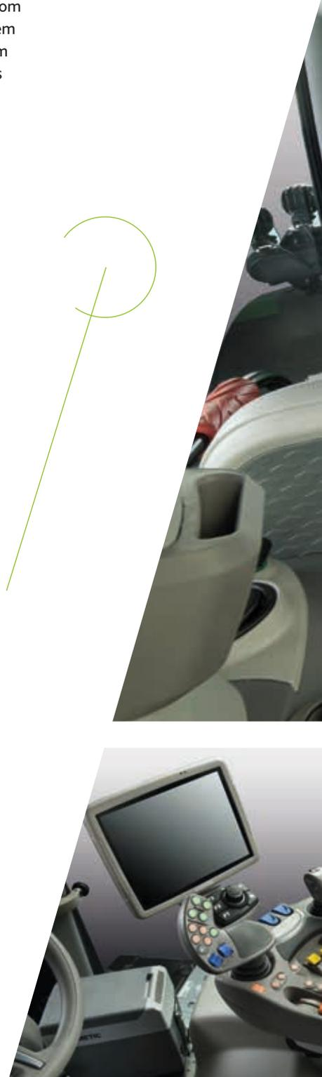
> Para controlar os distribuidores elétricos na cabina MaxiVision<sup>Pro</sup>, o operador pode escolher entre os controlos azuis na ponta dos dedos, o pequeno joystick ou as práticas rodas seletoras no joystick MaxCom.
