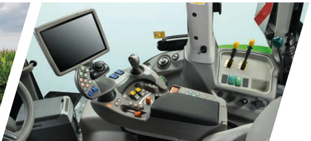
> Joystick MaxCom ergonômico com botões de elevação, controles do motor/transmissão, botão de gestão na cabeceira e duas unidades de controle da válvula hidráulica proporcional
