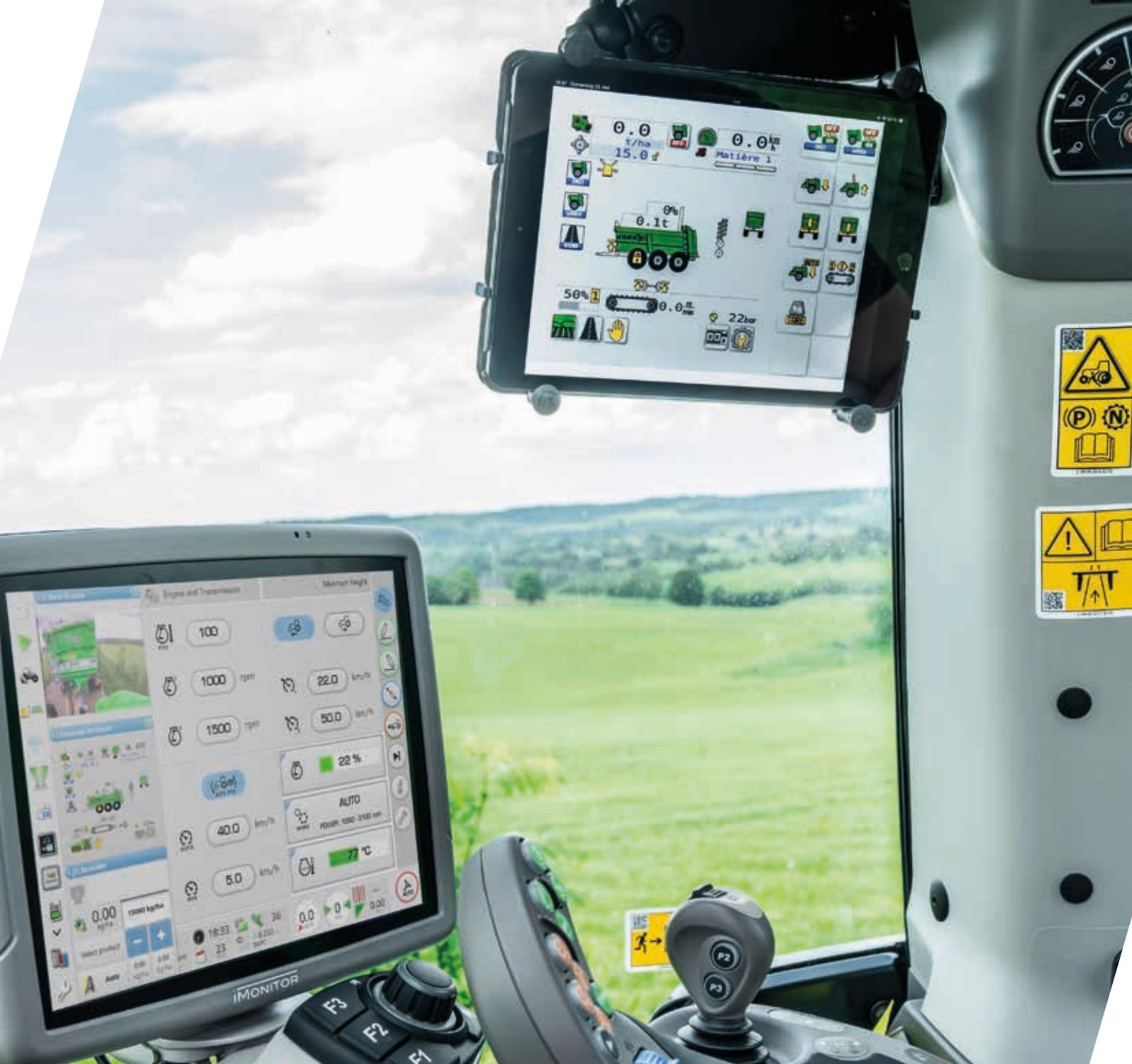
> A função XTEND permite a visualização da SDF Guidance ou o controlo de um equipamento ISOBUS num dispositivo externo como, por exemplo, um tablet.
