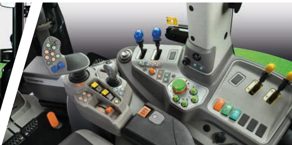
> Configuração mista com 2 distribuidores mecânicos e 2 elétricos.
