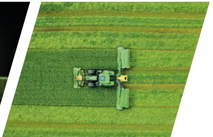
> O SDF Guidance, em combinação com o ComforTip<sup>Pro</sup> e AUTO-TURN, assegura que o trator funciona de forma totalmente automática, gerindo todas as operações no campo e nas cabeceiras com base em limites predefinidos. Este sistema alivia o condutor e garante o máximo conforto.
