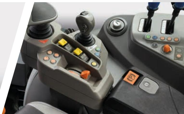
> Travão de estacionamento eletrônico (EPB) nos modelos TTV.
