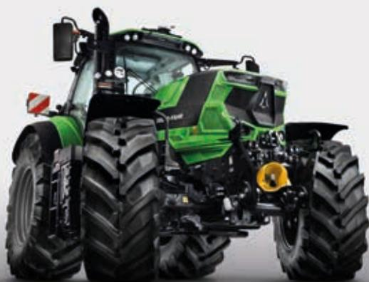
> Eixo dianteiro suspenso com bloqueio do diferencial dianteiro a 100%.
