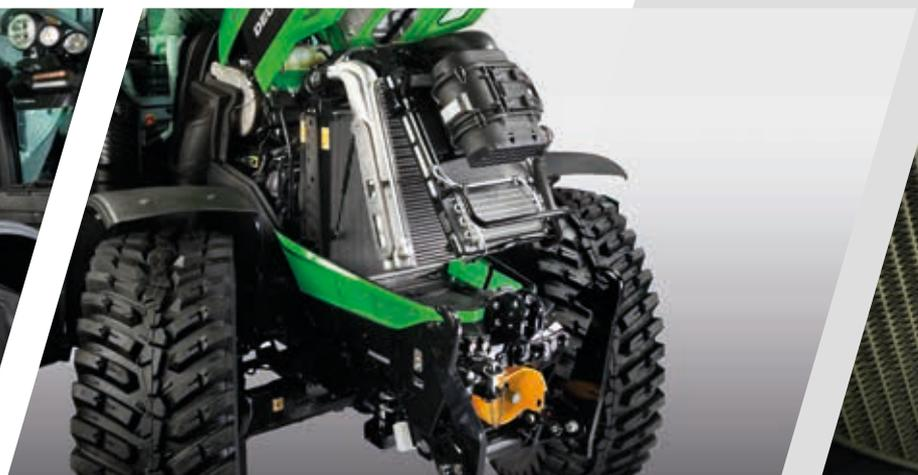
> Desempenho do sistema de refrigeração em alumínio<sup>pro</sup> com alavanca de desbloqueio de uma mão para os modelos 6210-6230.
