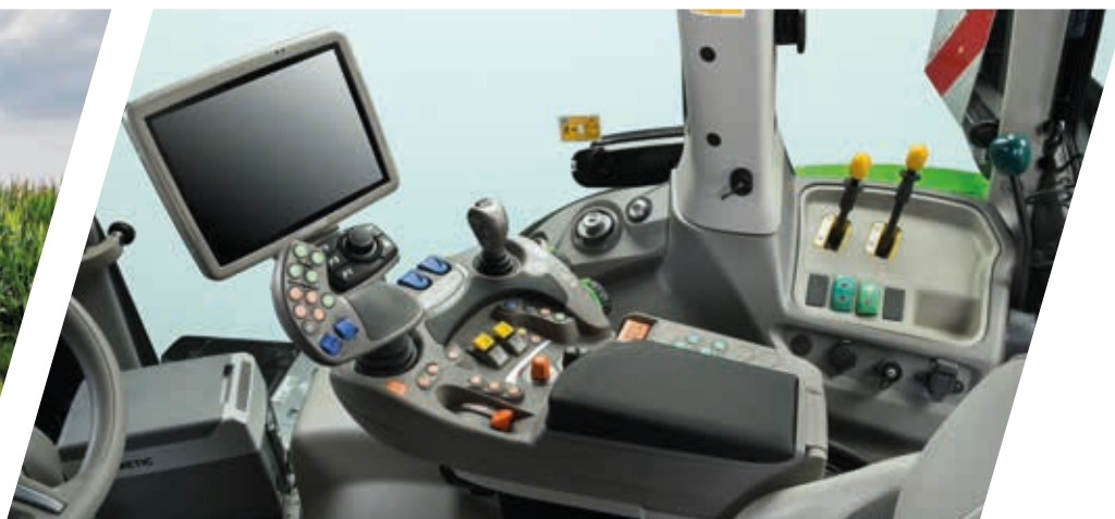
> Ergonomiczny joystick MaxCom z przyciskami do obsługi podnośników, sterowania silnikiem/przekładnią, pracą na uwrociach i dwoma proporcjonalnymi zaworami hydraulicznymi..
