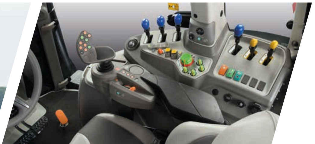
> Wyposażenie kabiny MaxiVision z w pełni mechanicznymi tylnymi zaworami suwakowymi w połączeniu z przekładnią Powershift (duże zdjęcie) i RCshift (zdjęcie powyżej).
