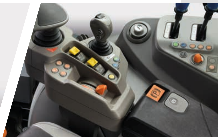
> Elektronische parkeerrem (EPB) op TTV-modellen.
