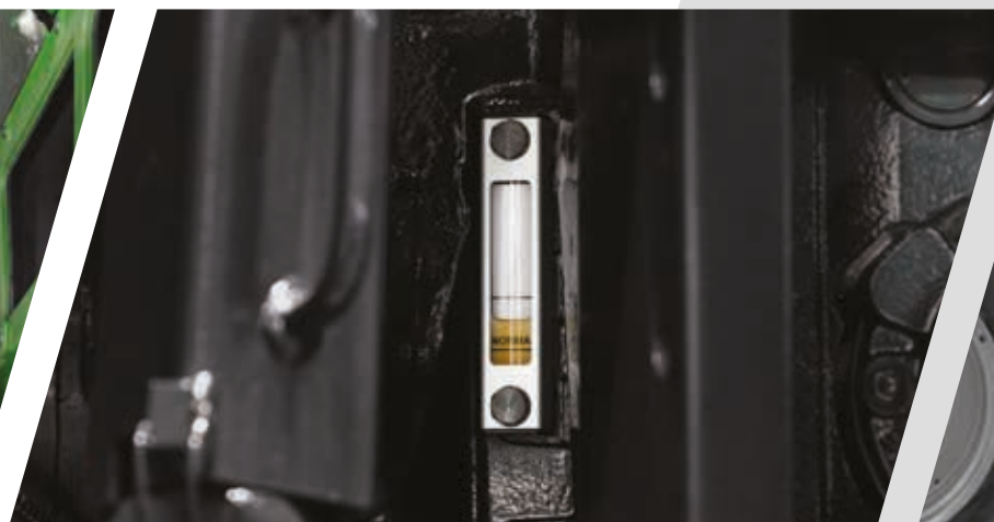
> Eenvoudig oliekijkglas aan de achterkant van de tractor.
