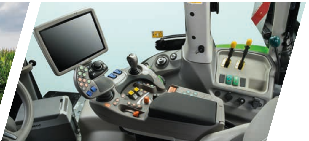
> Ergonomische MaxCom-joystick met bedieningen voor de hefinrichting, de motor, de transmissie, kopakkerwenningen en twee proportionele hydraulische kleppen.
