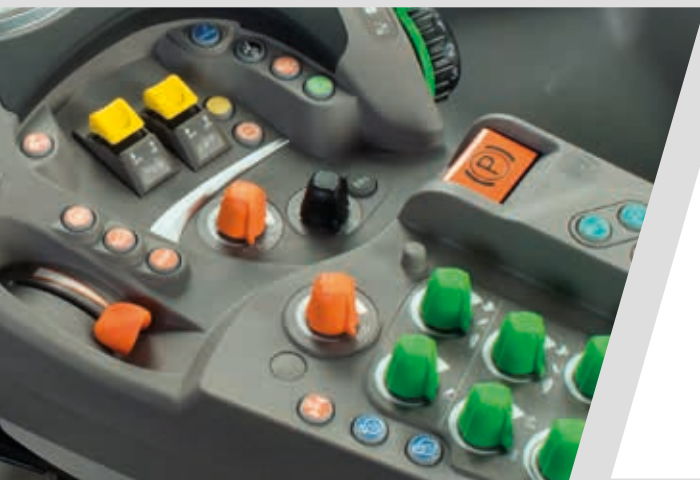
> Elektronisch handgas met instelbaar geheugen voor twee toerentallen.
