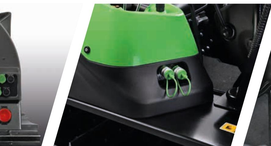
> I modelli 5 KF / 5 KM offrono sempre 2 collegamenti idraulici ventrali.
