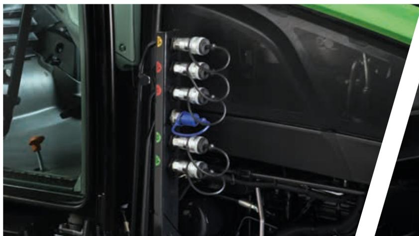
> Jusqu'à 5 voies hydrauliques ventrales.
