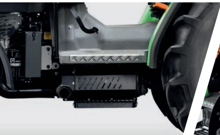
> Système EAT entièrement intégré. L'installation des systèmes SCR et FAP n'a pas d'incidence sur la hauteur des garde-boue et les dimensions du capot.
