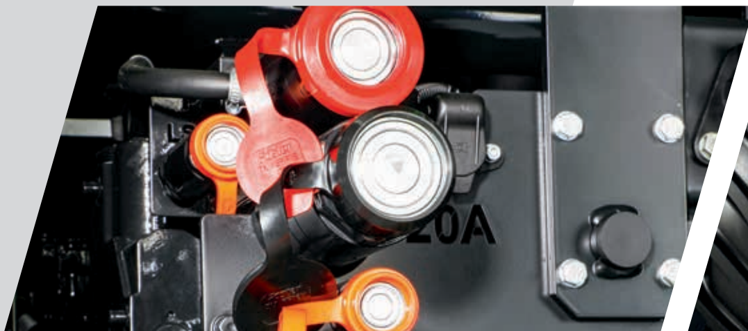
> Power Beyond avec coupleurs plats en option pour une connexion nette.
