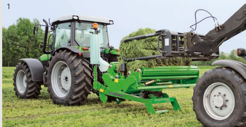
1 DE FAIBLE HAUTEUR, LA TABLE PERMET UN BASCULEMENT EN DOUCEUR DE LA BALLE AFIN D'ÉVITER TOUT ENDOMMAGEMENT DU FILM.
